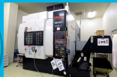
複雑な形状を持つ試作やテスト加工などを行う、5軸マシニングセンターも導入。医療分野への参入にあたって活用された
